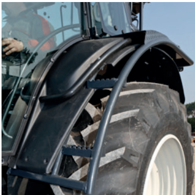
Scaletta di accesso integrata nel parafango trattore. Access stairway integrated in the tractor fender.
