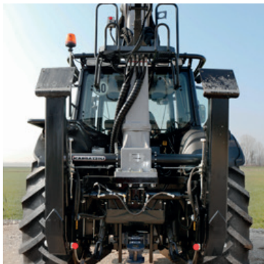
Vista posteriore con allestimento e staffaggio mod.ICAR e stabilizzatori orientabili. Rear view with preparation and clamping mod. ICAR and adjustable stabilizers.
