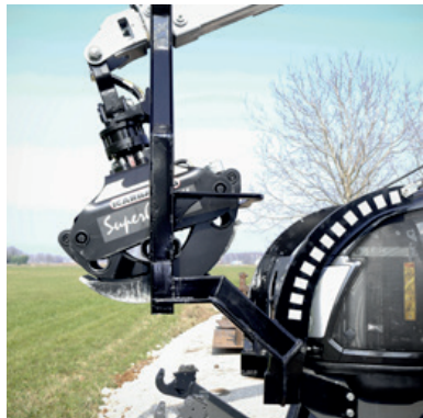
Supporto anteriore per braccio a riposo in fase di trasporto. Front support with arm resting during transport.
