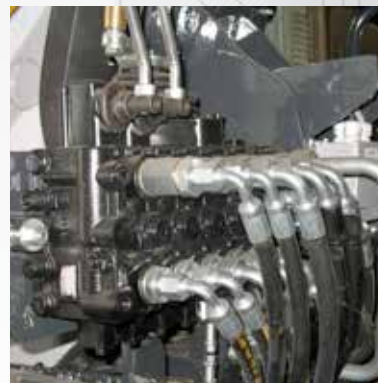
Distributori idraulici di comando proporzionali e compensati per effettuare contemporaneamente il maggior numero di movimenti. Compensating hydraulic distributors with proportional control to carry out the greatest number of movements simultaneously.
