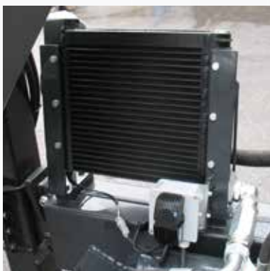
Scambiatore di calore automatico con centralina proporzionale per mantenere il circuito idraulico a temperatura costante.
