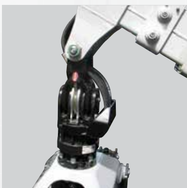
Sistema innovativo brevettato di antipendolo con tubazioni protette.
