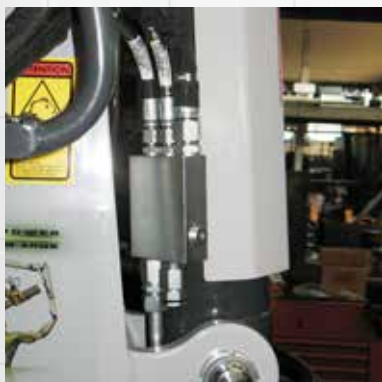
Dispositivi di sicurezza con valvole overcenter sui cilindri, limitatore di momento e sensori sugli stabilizzatori. Safety devices with over-centre valves on the cylinders, load moment limiter and sensors on the stabilizers.
