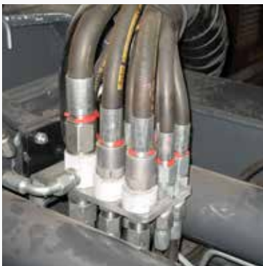
Tubazioni parker e raccordi girevoli brevettati a sgancio rapido per una superiore durata nel tempo dei tubi flessibili e per una manutenzione semplice e veloce. Parker pipe fittings and patented swivel connectors with quick release coupling to ensure longer lasting life of the flexible pipes as well as easy and quick maintenance.
