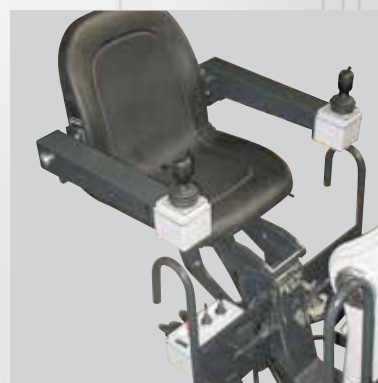
Distributore proporzionale danfoss completo di centralina elettronica per gestione e programmazione funzioni. Joystick proporzionali per montaggio esterno e schermatura contro interferenze. Danfoss pvg load independent spool valves complete with electronic control unit for managing and programming the functions. Equipped with proportional joysticks to be assembled externally and with anti-interference shielding.
