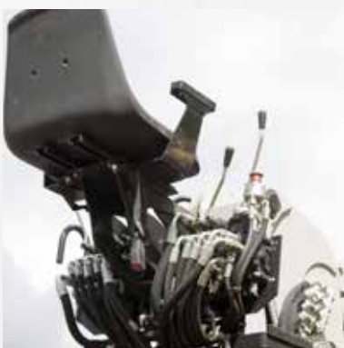
Postazione di comando ergonomica, dotata di leve a joystick (anche servoidrauliche) e comandi a pedale. Ergonomic driver's seat equipped with joystick levers (even servo-hydraulic ones) and foot-control levers.
